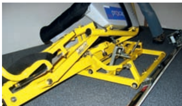
Kippmechanik wird über den Lenker beeinflusst.
