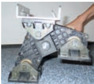
Kippmechanik ermöglicht limitiertes Aufkanten.
