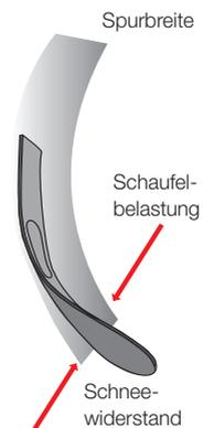
**Biegesteifigkeit:** Durch die unterschiedliche Längselastizität in den verschiedenen Skiabschnitten wird die Druckverteilung unter dem Ski verändert. Grundsätzlich ist ein Ski mit weichem Flex drehfreudiger als ein Ski mit hartem Flex.
